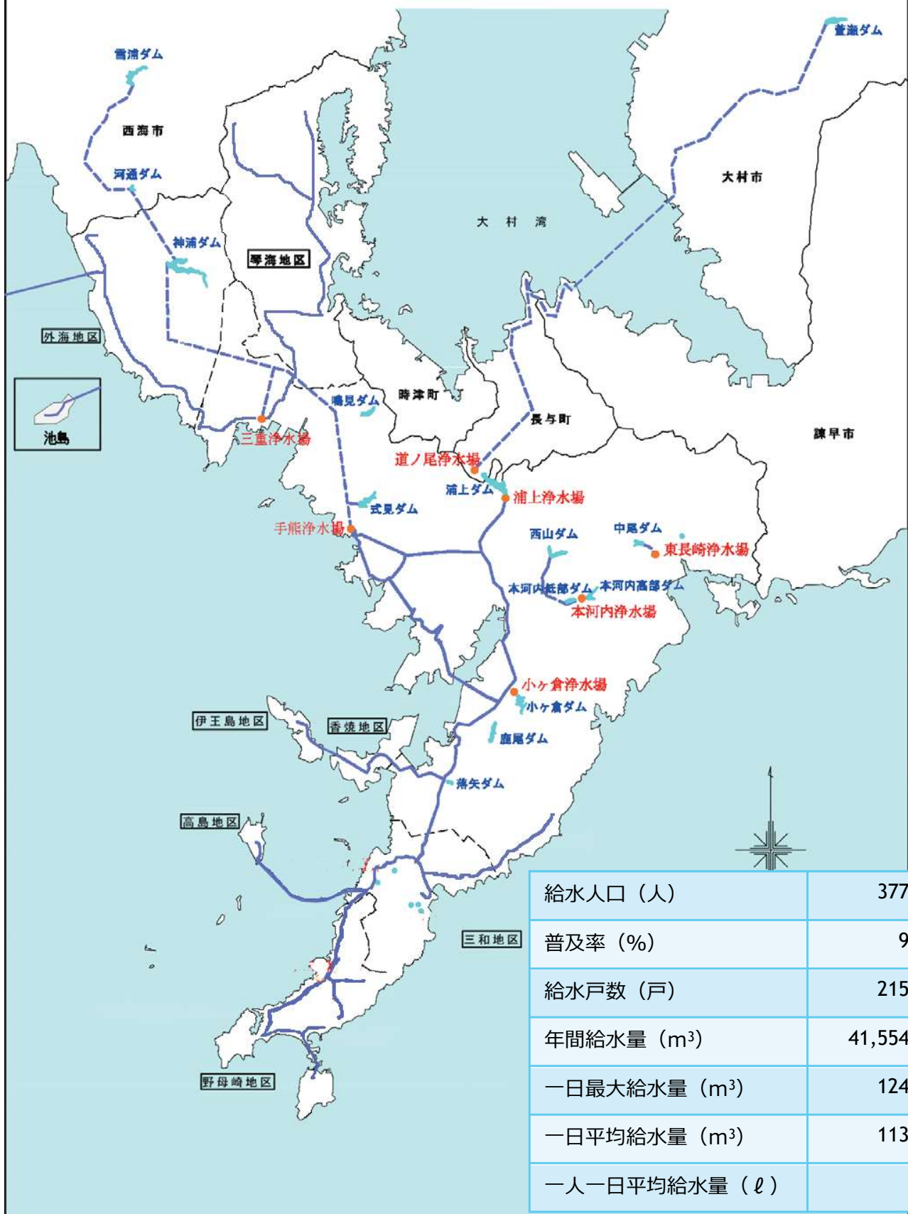
長崎市の主な水道施設及び令和6年度の給水状況
