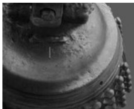
図10 龍頭の下の堰痕 （生成した3Dモデルにより図示）
