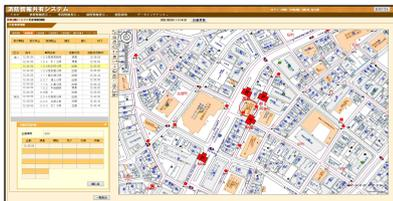
活動中の災害事案や車両の運用状況などのリアルタイムの情報を各消防署所で検索し、確認することができます。消防局、署所間で情報を共有し、連携して迅速・的確な災害対応を行うことができます。
