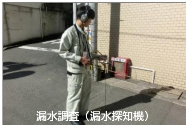
漏水調査（漏水探知機）
