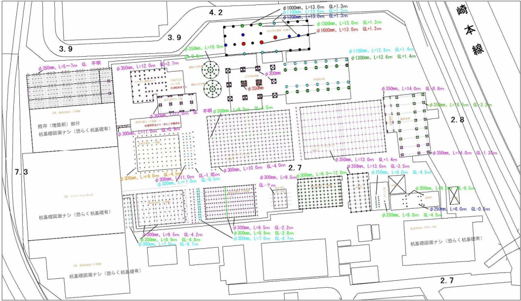
中部下水処理場の杭基礎配置図
