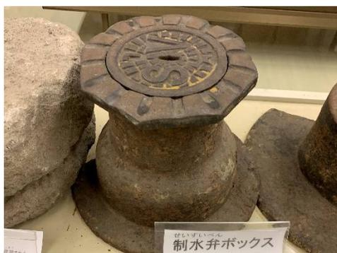
写真 3-61 制水弁ボックス
