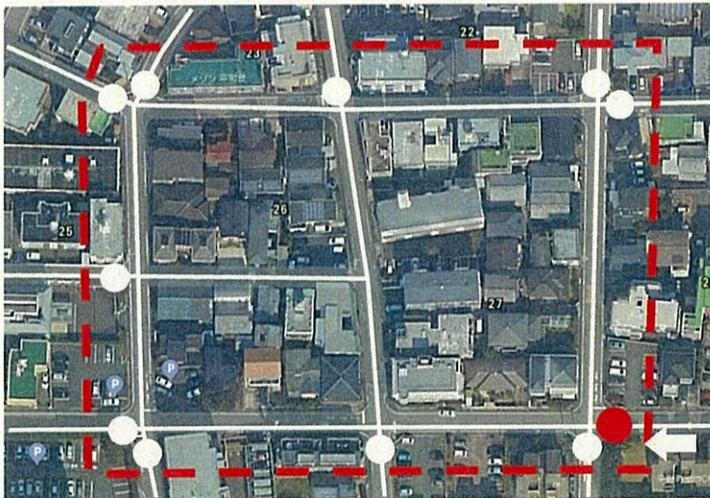
白色の丸印の仕切弁を閉めて、区画内への水の供給を赤色の丸印からに限定し、深夜の流量を測定して漏水の有無を判断
