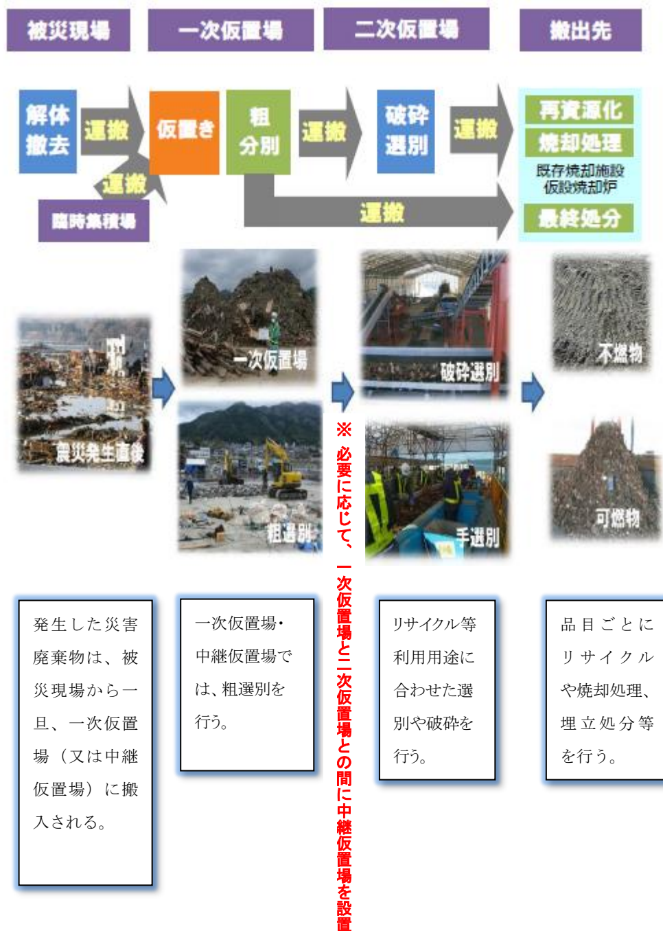
図2-3-5 仮置場への搬入、仮置場から搬出の流れ
