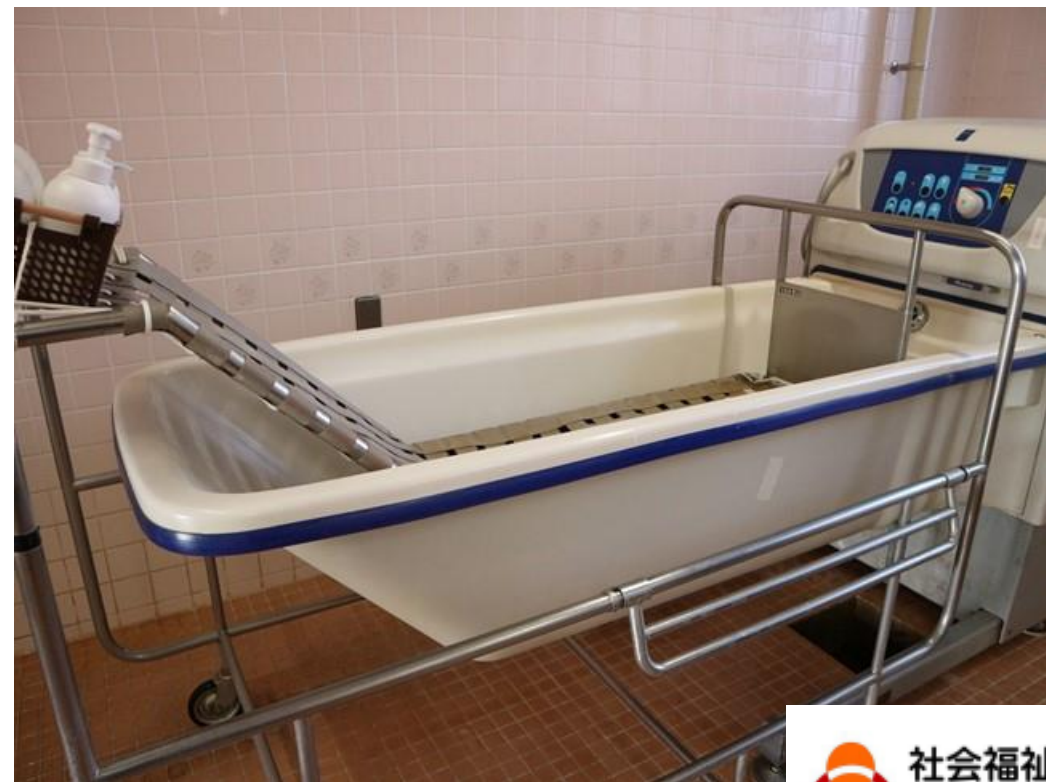
②浴槽が上昇し、入浴する構造
