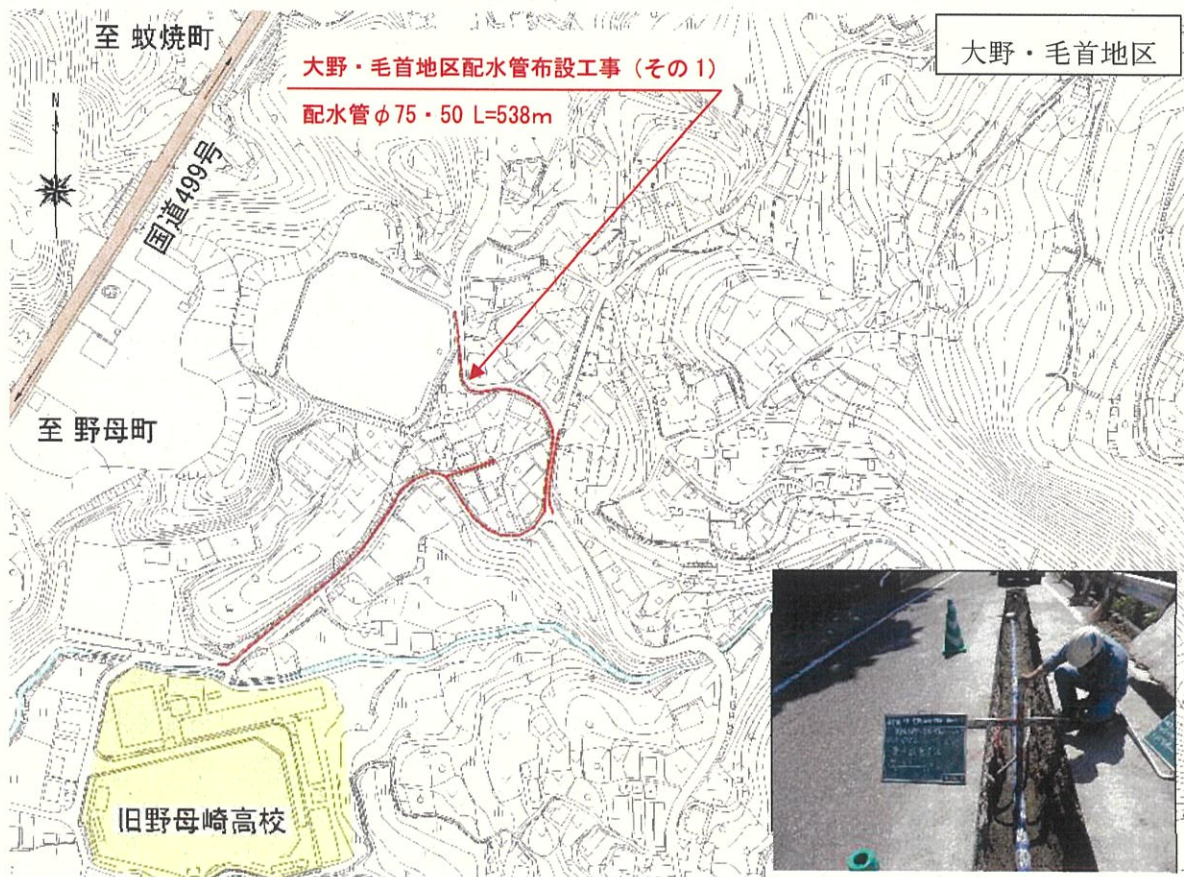
施工状況（φ75 送水管布設）
