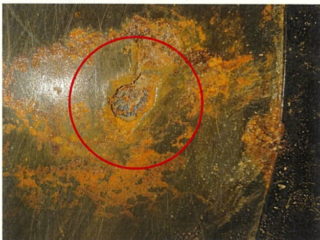
【 第 3 段階 貫通腐食 】 (管の腐食が進行し、管に穴が開いている状態) (下部損傷状況)
