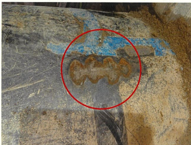
【 第 2 段階 表面腐食 】 (塗膜の損傷部から、管の表面まで腐食が進行している状態) (側部損傷状況)
