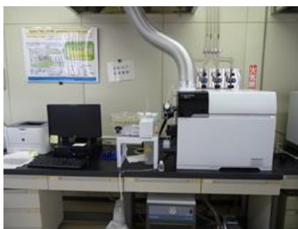
ICP質量分析装置 (金属類の分析)
