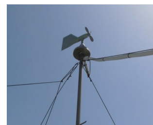
🌬️ 風向風速計も設置されています。
